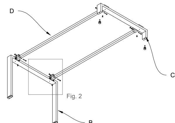
Fig.1 Inserire i bulloni (T e L) nel piano (A) attraverso i distanziali
